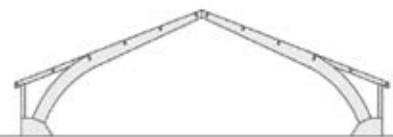
Rys. 8. Dźwigar gięty o stałym lub zmiennym przekroju (typu „hokej”), tworzący dach dwuspadowy z zachowaniem łukowej formy wewnątrz budynku. Maksymalny spadek dachu praktycznie bez ograniczeń, dzięki układowi trójprzegubowemu złożonemu z dwóch elementów możliwe do uzyskania olbrzymie rozpiętości.
