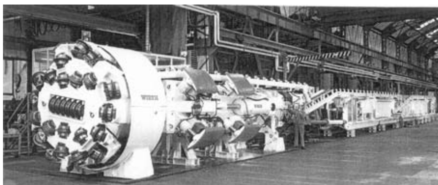
Fot. 1. Głowica urabiająca skałę punktowo
