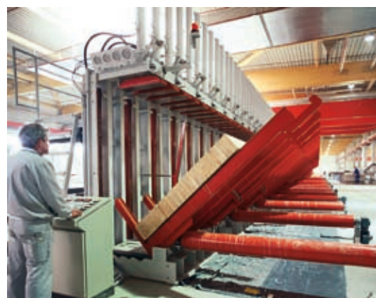
Układanie lameli w prasie
