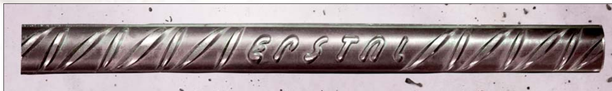
Fot. 1 | Wzór uźebrowania gatunku B500SP oraz trwałe znakowanie stali EPSTAL
