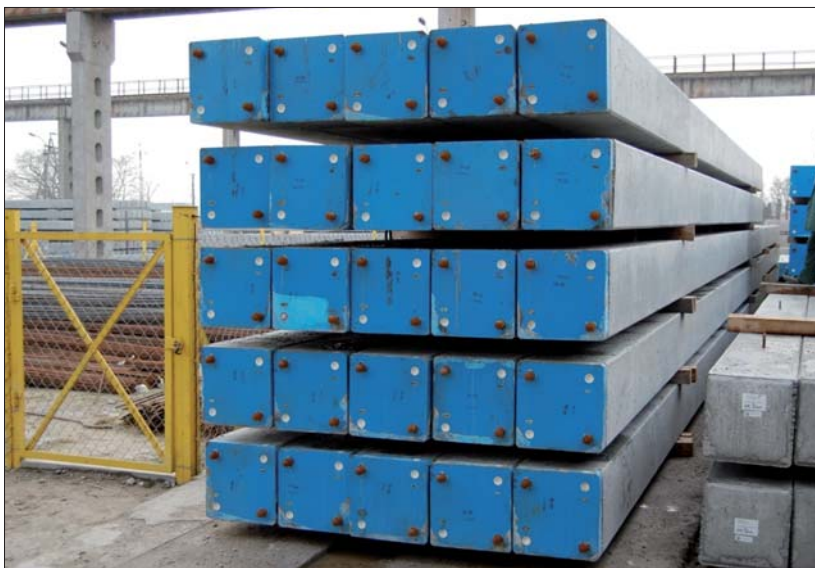
Fot. 1 | Pile z łącznikami na placu wytwórni
