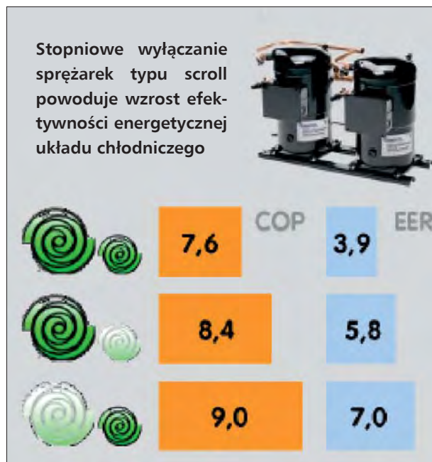
Rys. 2 | Aktywny termodynamiczny odzysk ciepła oprócz bardzo wysokiej efektywności przy maksymalnym obciążeniu cieplnym cechuje się jeszcze wyższą efektywnością energetyczną zarówno w trybie grzania, jak i chłodzenia w warunkach częściowego obciążenia cieplnego. Stopniowa sekwencyjna dezaktywacja poszczególnych sprężarek powoduje zatem dalszy wzrost efektywności
