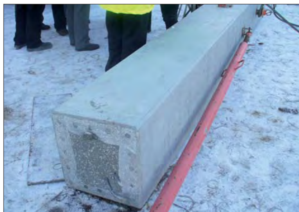
Fot. 1 | Słup zdemontowany dla pobrania próbek
