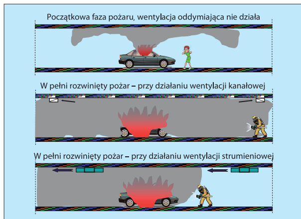
Rys. 2 | Porównanie skuteczności działania systemu kanałowego i bezprzewodowego
