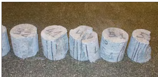
Fot. 2 | Próbkę po badaniach niszczących
