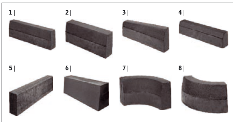
Fot. | Krawężniki drogowe w ofercie Polbruk S.A.: 1. lekki – 100 x 15 x 30 cm; 2. ciężki – 100 x 20 x 30 cm; 3. skośny – 100 x 15 x 22/30 cm; 4. wjazdowy – 100 x 15 x 22 cm; 5. opornik – 100 x 12 x 25 cm; 6. trapezowy – 100 x 30 x 15/21 cm; 7. łukowy zewnętrzny – 78,5 x 15 x 30 cm i r = 0,5; 1; 2; 3; 5; 8; 12 cm; 8. łukowy wewnętrzny – 78,5 x 15 x 30 cm i r = 0,5; 1; 2; 3; 5; 8; 12 cm
