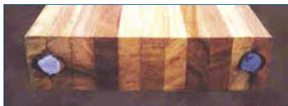
Fot. 1. Dźwigar drewniany zbrojony stalą
