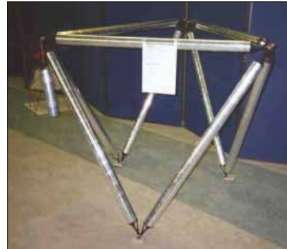
Fot. 5. Kratownica aluminiowa, – imitacja bambusa z puszek aluminiowych – Walter Janach, Szwajcaria
