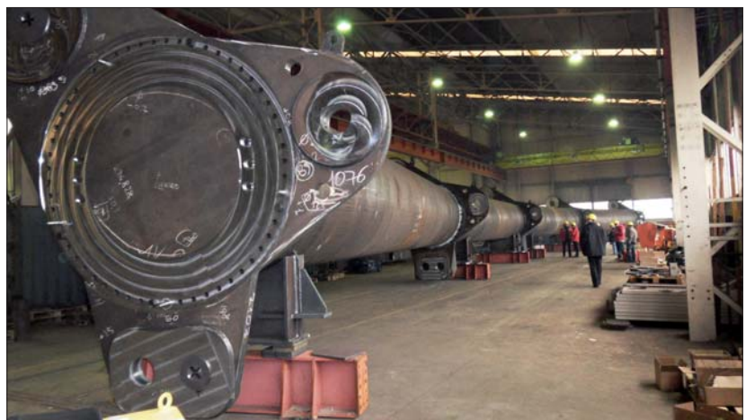
Fot. 2 | Próby montaż pierścienia ściskanego
