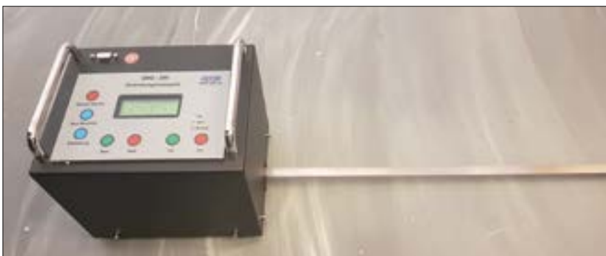
Fot. 1. Urządzenie do badania współczynnika tarcia kinetycznego posadzki z żywicy Sika Comfortfloor® PS - 63
