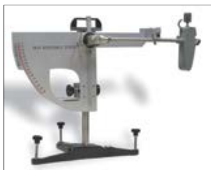
Fot. 1. Przyrząd do badania śliskości posadzek metodą wahadła
