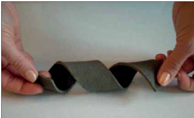
Fot. 1 | Wizualizacja cech sprężystych paska z powłoki polimocznikowej
