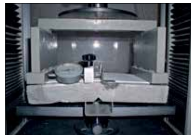
Fot. 2 | Badania cyklicznych obciążeń powłoki wykonanej z polimocznika MasterSeal
