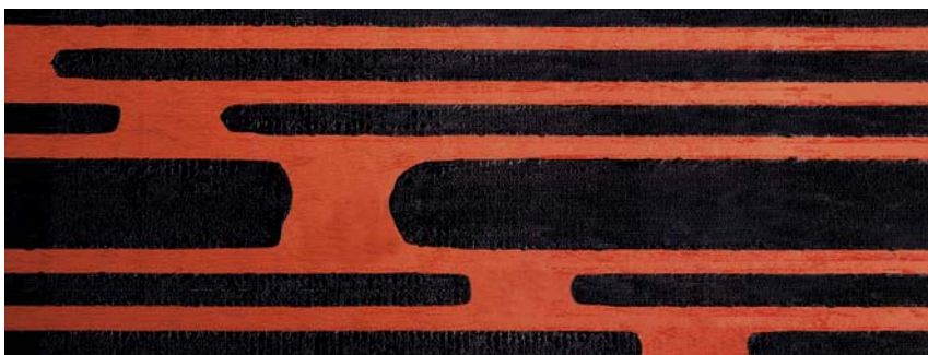
Połączenie papy EXTRA-WENTYLACJA TOP5 SZYBKIE SYNTAN® SBS z podłożem wytrzymuje próby oderwania. Zerwanie następuje na płaszczynie osnowy papy, do której zgrzana została papa Szybki Syntan® SBS.
