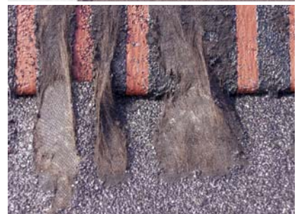
Połączenie papy EXTRA-WENTYLACJA TOP5 SZYBKIE SYNTAN® SBS z podłożem wytrzymuje próby oderwania. Zerwanie następuje na płaszczynie osnowy papy, do której zgrzana została papa Szybki Syntan® SBS.
