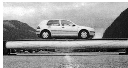
Fot. 20. Test mostu o rozpiętości 8 m i nośności 3,5 t
