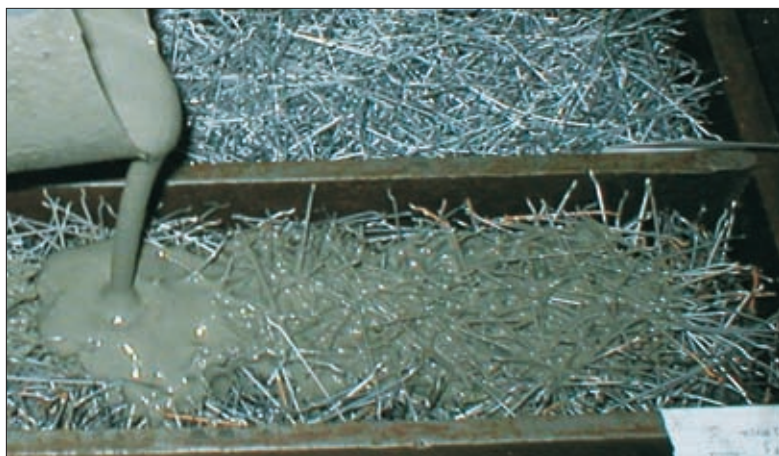
Fot. 1 | Proces wykonywania elementu typu SIFCON (fot. autor)
