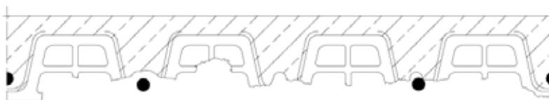
Fot. i rys. 1. Stan techniczny wybranych stropów Ackermana nad piwnicami nie użytkowanymi: a) widok stropów, b) poglądowy schemat uszkodzeń elementów stropów.
