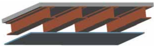
Rys. 6. Zabezpieczenie ogniochronne grupowe za pomocą ścian
