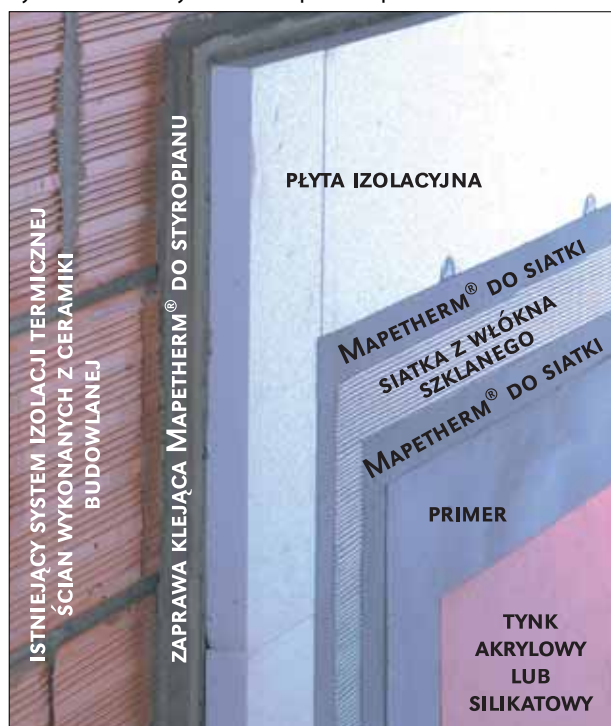
Rys. 1. Schemat systemu ociepleń Mapetherm®
