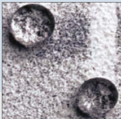
Fot. 1. Oczyszczanie powłoki z zanieczyszczeń przez krople wody
