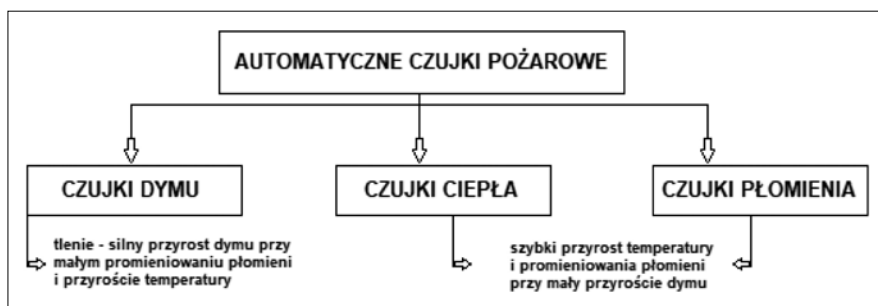
Rys. 2. Podstawowy podział najczęściej stosowanych czujek pożarowych (opracowanie własne)
