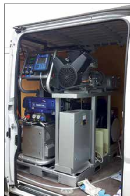
Fot. 10. Agregat do aplikacji izolacji natryskowych (archiwum firmy Compact-Project)
