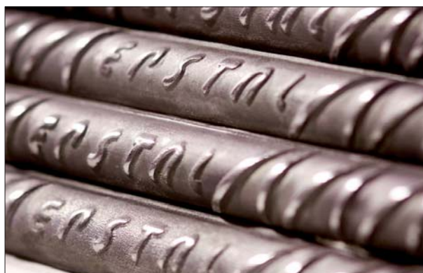
Fot. 2 Stal EPSTAL ma napis „EPSTAL” nawalcowany na prętach, dzięki czemu jest jednoznacznie rozpoznawalna i łatwa w identyfikacji na budowie
