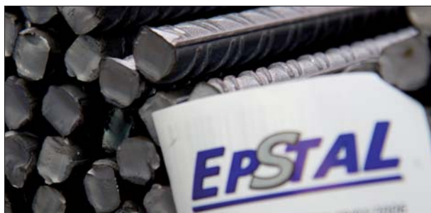
Fot. 1 Stal EPSTAL ma etykietę zawierającą informacje niezbędne do identyfikacji prętów. Etykieta jest przytwierdzona do każdej wiązki prętów dostarczonej na budowę
