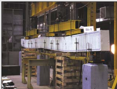
Fot. 1. Zachowanie się konstrukcji zbrojonych stalą o podwyższonej ciągliwości – klasa C
