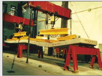
Fot. 1. Zachowanie się konstrukcji zbrojonych stalą o podwyższonej ciągliwości – klasa C
