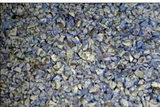
Fot. 4 | Wytarta powierzchnia warstwy użytkowej wykonana z granulatu SBR pokrytego farbą
