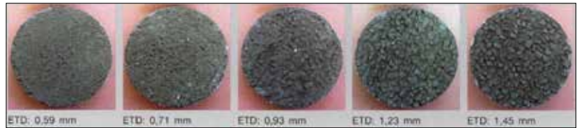
Fot. 8 | Zdjęcia odwiertów z nawierzchni betonowej z odsłoniętym kruszywem obrazujące różne głębokości tekstury (wartości EDT w mm) (źródło: inż. J. Skarabis, TU München, publikacja w Griffig 2/2014)
