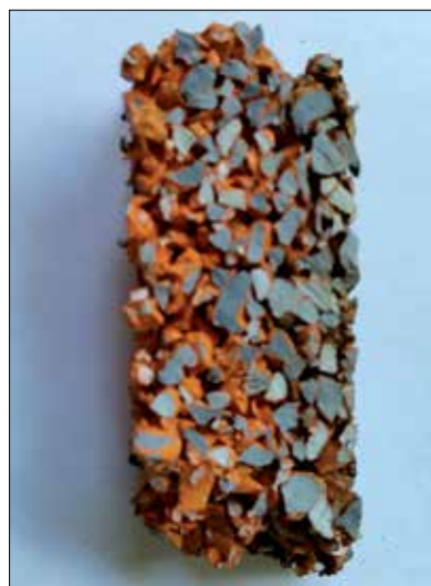
Fot. 1 | Przekrój warstwy użytkowej z pokrytego farbą granulatu EPDM z recyklingu
