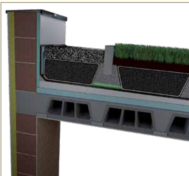
Dach zielony z drenażem z keramzytu
