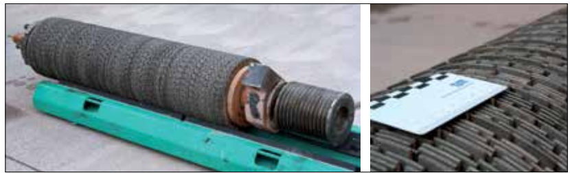
Fot. 11 | Główny element maszyny do teksturowania nawierzchni metodą Grinding (źródło: T. Alte-Teigeler, OAT GmbH)
