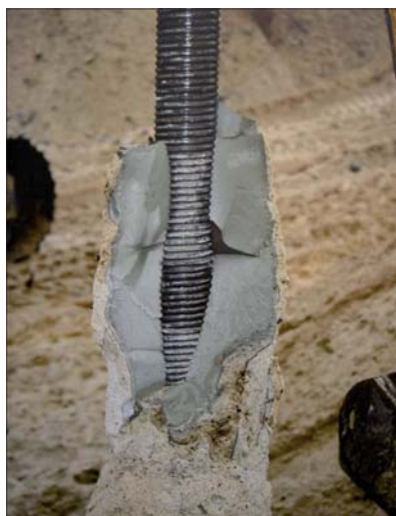
Fot. 3 | Widok mikropala geotermalnego (fot. Titan Polska)
