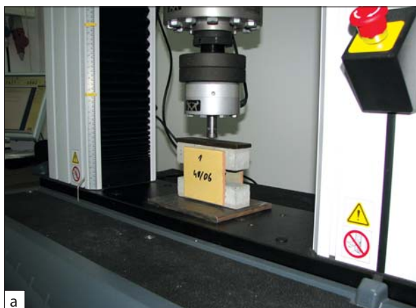
Fot. 2 a i b | Badanie odkształcalności poprzecznej wg [4]
