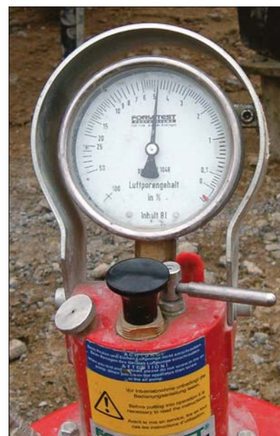
Fot. 1 | Aparat do badania zawartości powietrza
