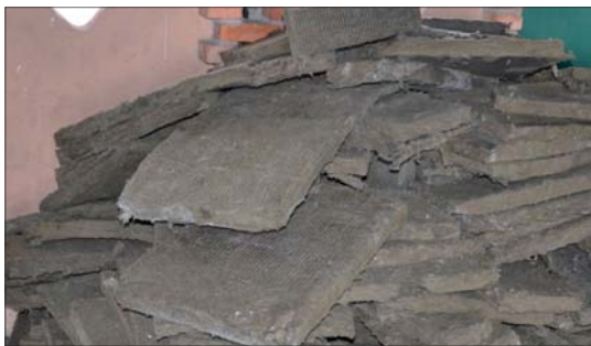
Fot. 1. Zdemontowane płyty z wełny mineralnej produkowane w latach 80. ubiegłego wieku
