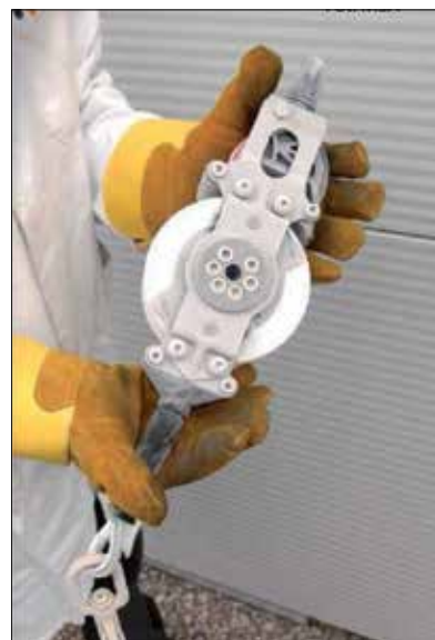
Fot. 5 | Testy odporności mechanizmów urządzenia na niską temperaturę i chemikalia
