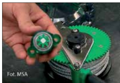
Fot. 3 | Mechanizm kontrolujący proces zwijania linki w urządzeniu samohamownym
