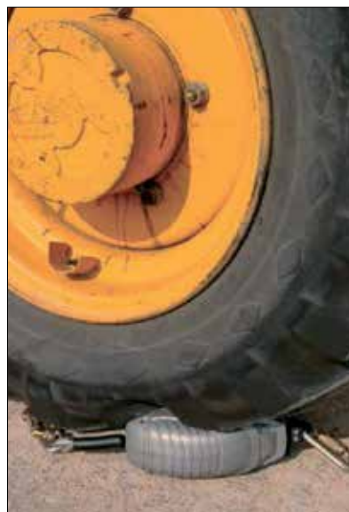
Fot. 4 | Testy odporności urządzenia na uszkodzenia obudowy
