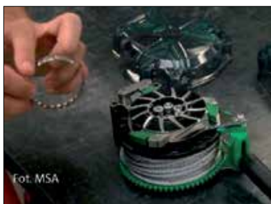
Fot. 1 | Pierścieni sprężysty jako przykład amortyzatora energii niewymagającego regulacji
