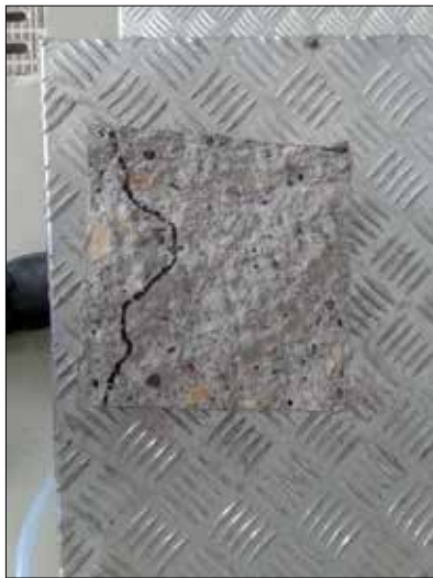
Fot. 2 | Kostka z betonu poddana działaniu ciśnienia wody. Zaznaczono głębokość penetracji wody (fot. autor)
