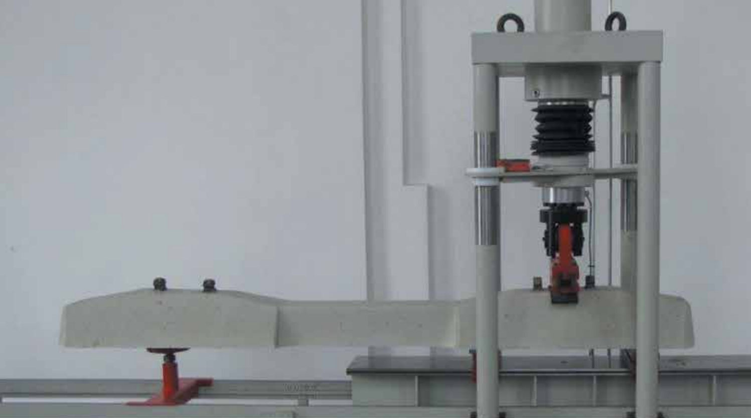
Fot. 2 | Badanie podkładów strunobetonowych Track Tec
