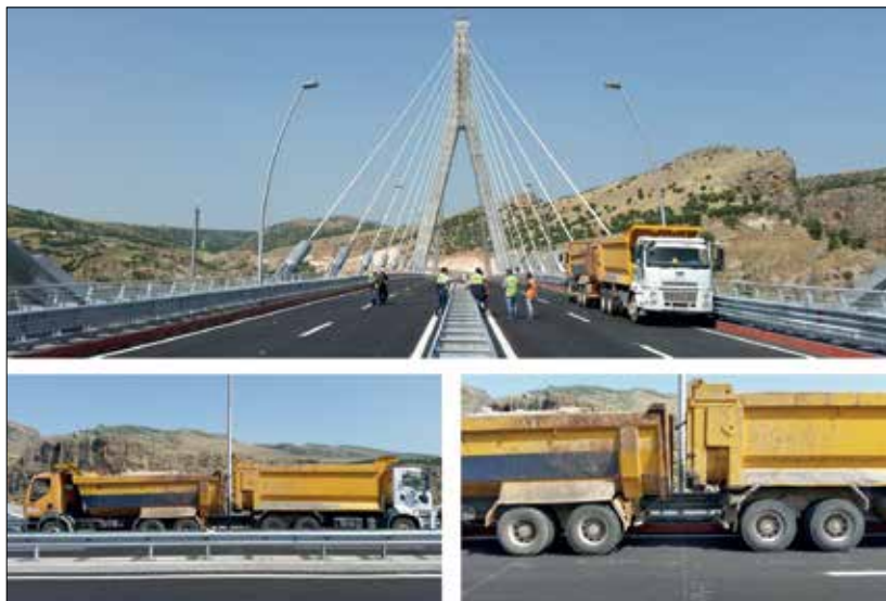
Fot. 5 | Statyczne obciążenia próbne
