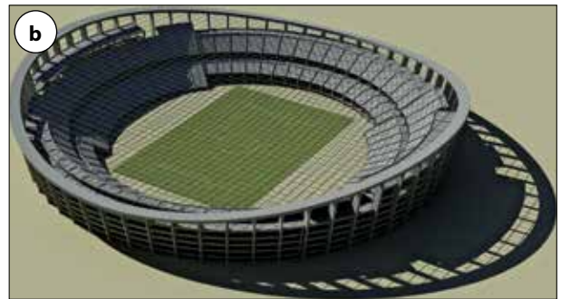
Rys. 6 | Schematy rozwiązania: a) linie wzroku widzów padające na krawędź boiska, b) zacięcie łoża VIP-ów i sekcji mediów
