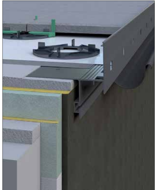
Fot. 7 | Taras – wariant drenażowy – warstwa użytkowa z płyt betonowych układanych na podstawkach dystansowych. Bezwzględnym wymogiem jest stosowanie profili okapowych dostosowanych do systemu hydroizolacyjnego i warstw drenażowej i użytkowej (fot. Renoplast)
