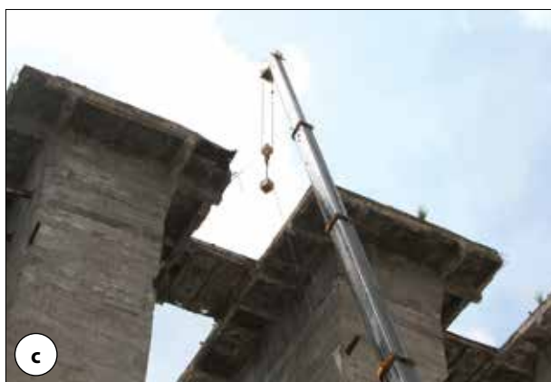
Rys. 3 | Faza badań przygotowawczych: a) ciężarki zrzucane z wysokości; b) podłoże osłonięte warstwą tłumiącą; c) ciężarek zamocowany na wysięgniku dźwigu; d) przykładowy sejsmogram drgań zarejestrowanych w czasie badań
