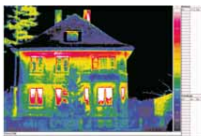
Fot. 1–2. Zdjęcia termowizyjne: 1 – dom jednorodzinny z początku XX w., 2 – dom z końca XIX w. z murem pruskim. W obu przykładach widoczne są nadmierne straty przez ściany, wnęki podokienne, nadproża okienne, podokienniki oraz stolarkę okienną
