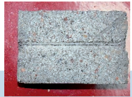
Fot. 2. Przykład próbki po badaniu z widocznym kanałikiem, w którym umieszczona jest termopara mierząca temperaturę na styku zbrojenie – beton
