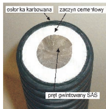
Rys. 2. Przekrój poprzeczny i podłużny pręta SAS z zabezpieczeniem DCP
