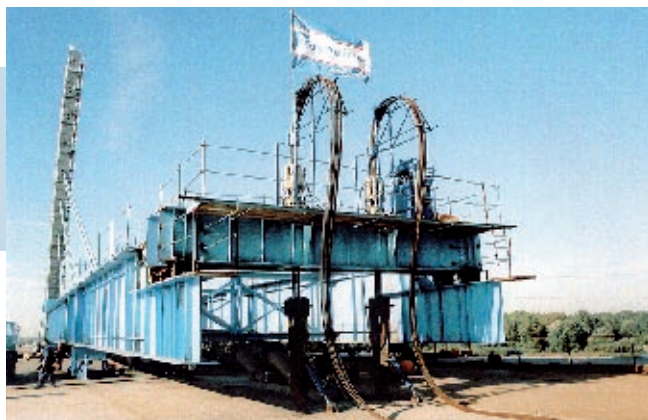
Fot. 6. Żuraw w widoku od przodu. Na głównych dźwigarach blachownicowych spoczywa belka poprzeczna z urządzeniami hydraulicznymi. Widoczne także liny i zawiesia
