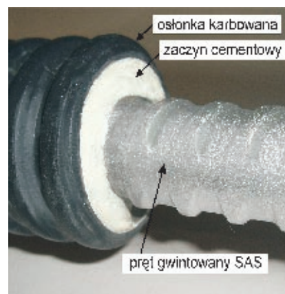
Fot. Przekrój i widok pręta SAS z zabezpieczeniem DCP
