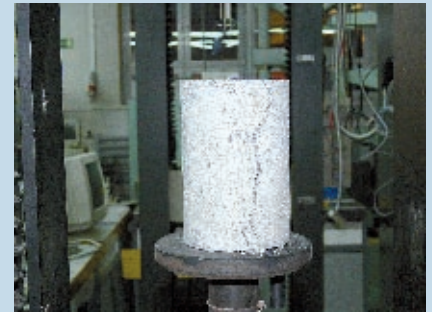
Fot. 3. Badanie „na zimno” – przykład typowego zniszczenia. Stal A, temperatura 700°C
