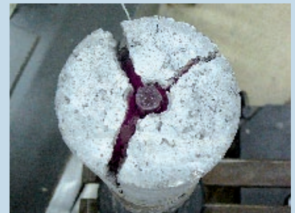
Fot. 4. Badanie „na gorąco” – przykład typowego zniszczenia. Stal C EPSTAL®, obciążenie 12 kN
