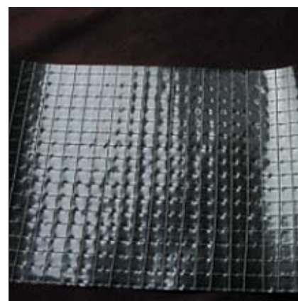
Fot. 4. Folia paroszczelna polietylenowa, laminowana folią aluminiową ( Braas Izo – 156 g/m 2 )
