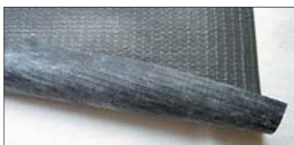
Fot. 7. Folia PE paroprzepuszczalna zbrojona siatką PP, z włókniną polietylenową – przepuszczająca parę wodną, nieprzepuszczająca wody; stosowana do dachów niewentylowanych ( Braas Open – 120 g/m 2 , paroprzepuszczalność 500 g/m 2 /24 h, S d = 0,08 m)
