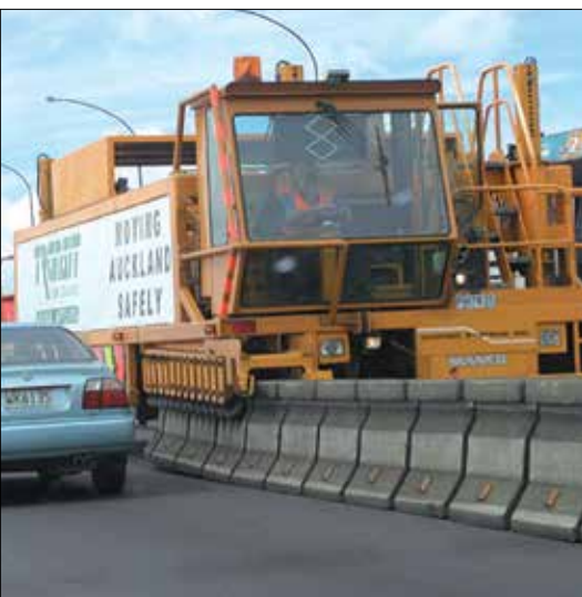
Fot. 8 | Maszyna do zmiany położenia bariery oddzielającej dwa kierunki ruchu na moście Auckland Harbour (fot. wikimedia, Alan Levine)
