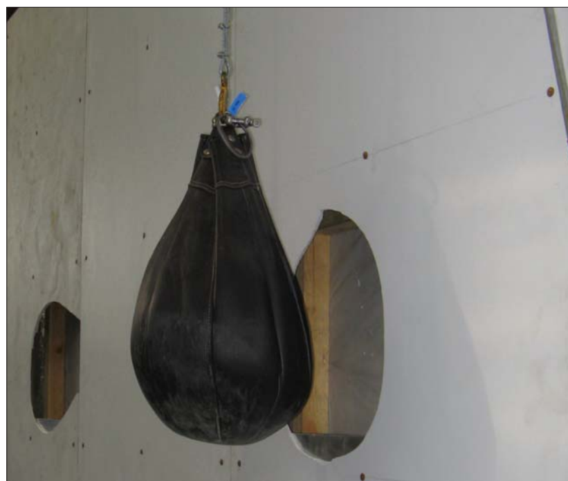
Fot. 2 | Badania odporności okładziny elewacji wentylowanej na uderzenie ciałem miękkim
