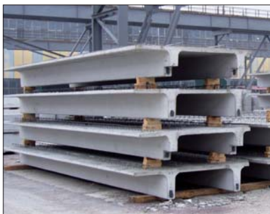
Fot. 4 | Płyty TT na składowisku
