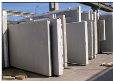
Fot. 5 | Prefabrykowane elementy ścienne
