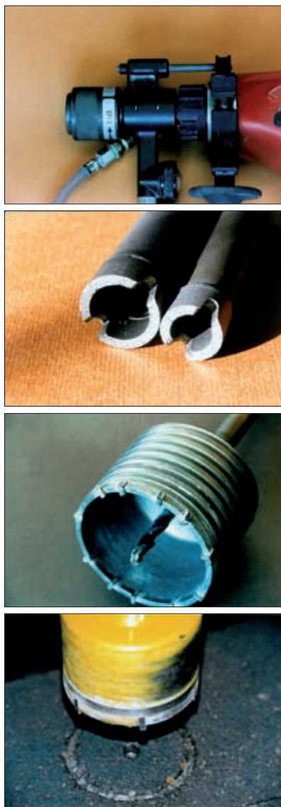
Fot. 4 | Elementy zestawu wykorzystywane do wykonywania otworów w płytach fakturowych
