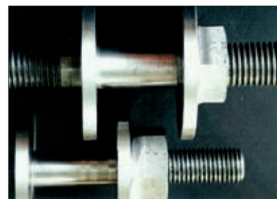
Fot. 3 | Kotwie typu „L” i „C” zrealizowane do badań w skali naturalnej
