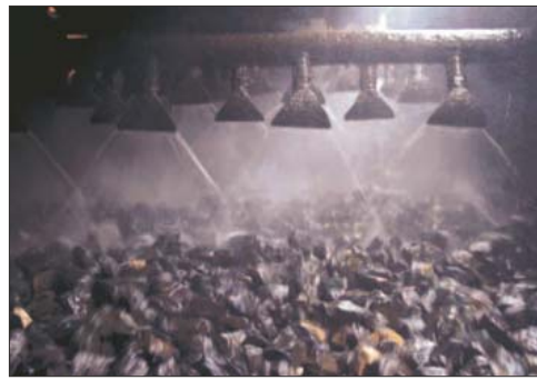
Fot. 8. Widok maszyny PM 200-2R do wymiany nawierzchni (z lewej) płuczki ciśnieniowej czyszczącej podsypkę (z prawej) [2]
