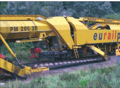
Fot. 8. Widok maszyny PM 200-2R do wymiany nawierzchni (z lewej) płuczki ciśnieniowej czyszczącej podsypkę (z prawej) [2]
