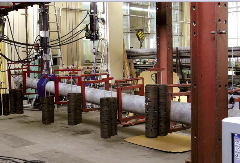
Fot.1. Badania wytrzymałościowe słupa żelbetowego sprężonego wirowanego na stanowisku stendowym przy jednoczesnym zginaniu i skręcaniu w laboratorium ITB
